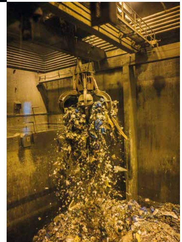
Der Greifer im Bunker transportiert den Müll in den Aufgabetrichter des Kessels
